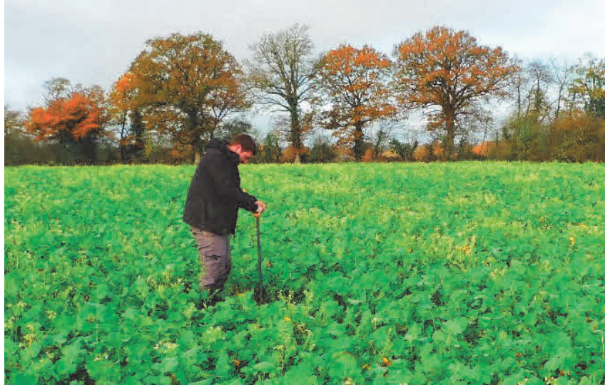
Prélèvement à l'aide d'une tarière pédologique - Calidris
